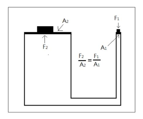
• Use a small push-down force to generate a large push-up force 利用小的向下力来产生大的向上推举的力
